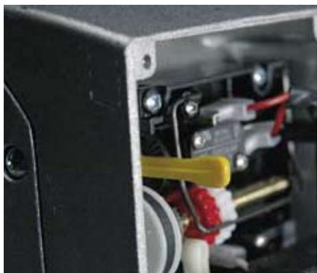
Версии с механическими концевыми выключателями оснащены микрометрической регулировкой, позволяющей быстро и точно отметить конечное положение створок ворот в закрытом состоянии.
