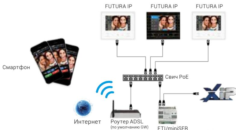
Схема подключения с локальным блоком питания
