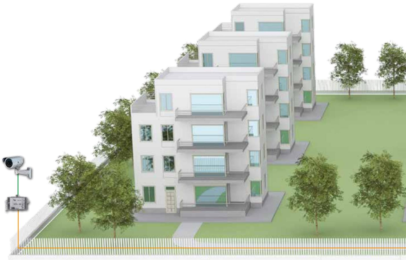
Системы для небольших жилых комплексов могут быть построены на основе магистрали, соединяющей главный вход(ы) и отдельные здания (частные и/или многоквартирные дома). В данном случае в качестве кабеля в магистрали используется витая пара (например UTP) или кабель производства ВРТ - VCM/1D (для наибольшей производительности). Для объединения зданий рекомендуется кабель VCM/4D.
