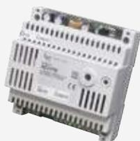
Модуль AZV/PSI - это универсальный блок питания со специальными клеммами для подключения четырёхпроводных вызывных панелей. При помощи специальных блоков сопряжения сторонних производителей к AZV/PSI могут быть также подключены вызывные панели цифровых и/или координатно-матричных систем домофонии. Модуль оснащен блоком питания для вызывных панелей и абонентских устройств BPT, что позволяет сэкономить пространство в монтажном щитке при установке.
